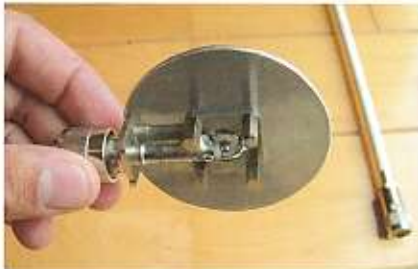
De samenstelling van twee N-type chassisdelen, vier 10 mm afstandbussen en een aluminium grondplaat.
